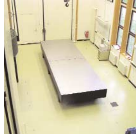
Optischer Tisch 2 x 6m mit aktiver Dämpfung für den Spektrographen
