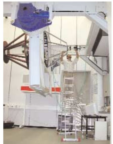
Erste Tests der AGWs am Teleskop-simulator wurden abgeschlossen. Die Biegunstests waren erfolgreich: Bei einer Belastung von 2t wurden nur 0.06 mm Verbiegung gemessen, obwohl die Toleranz bei 0.2 mm liegt. Der Bau weiter drei AGW-Einheiten wurde begonnen.
