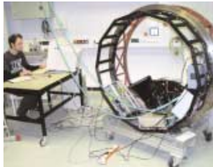
Test der Motorsteuerung einer AGW-Einheit
