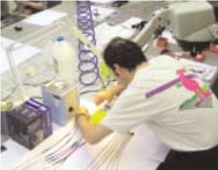
Glasfasertechnik: Beim Bündeln der Fasern
