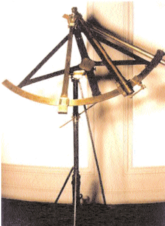
Quadrant von Langlois, von P. de Maupertuis in Lapland benutzt, um die Abplattung der Erde zu bestimmen.
