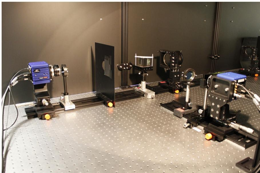
**Abbildung 3.5** Aufbau des HiFI-Systems auf optischer Bank. In der Mitte steht der 40/60 % Strahlteiler, der das einfallende Licht aufteilt (AIP).
