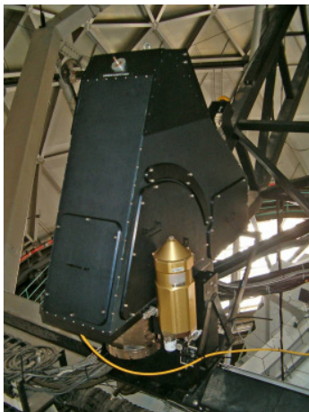
Bild 3: Der VIRUS-Spektrograph mit Faserbündel (gelbes Kabel) im Primärfokus des Hobby-Eberly-Teleskops (links). Computer-Design des Instruments (rechts). [Bild:AIP]
