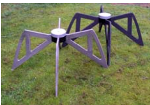
Abb. 2: LOFAR -Antennen für Radio-Wellenlängen 1-3 Meter. Je 96 Antennen beider Typen bilden eine Station. (Bild: ASTRON Dwingeloo/ Niederlande)
