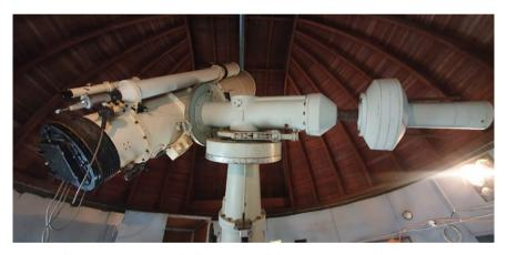
Bild 7. Der noch heute in Sonneberg existierende 40-cm-Zeiss-Astrograph aus dem Anfang der 1960er Jahre. Quelle: P. Kroll.
