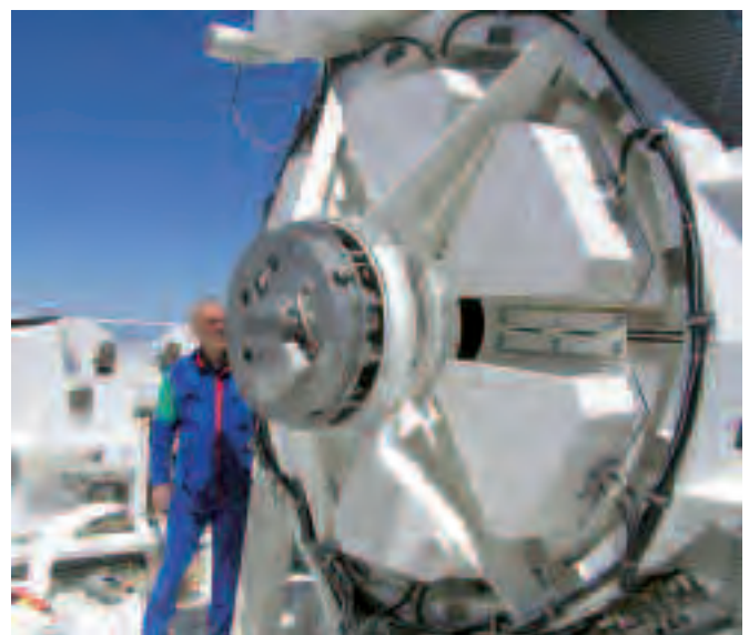
Abb.2: M3-Spiegeleinheit nach integration in die Teleskopstruktur.
