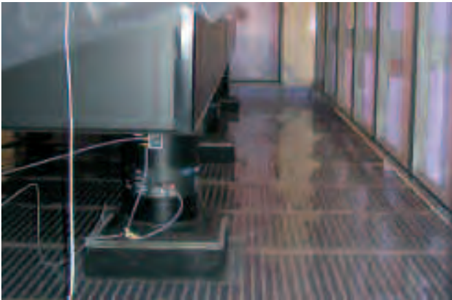
Die Heizung der PEPSI-Druckkammer, im Vordergrund der optische Tisch
