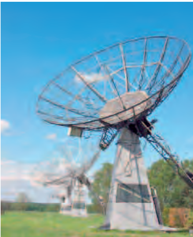
Fig. 1: Die 7,5 und 10 m Durchmesser-Antennen des Observatoriums fuer den Frequenzbereich zwischen 100 und 800 MHz.
