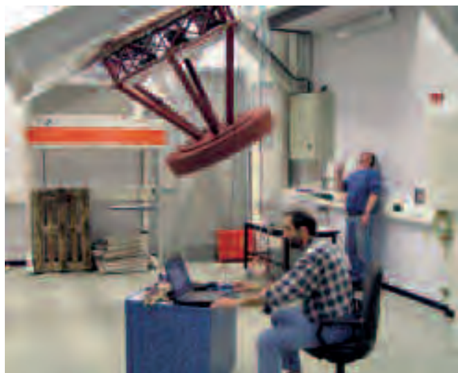
Fig. 3 Die AGW Einheit am Teleskopsimulator mit dem 2 t Gewicht
