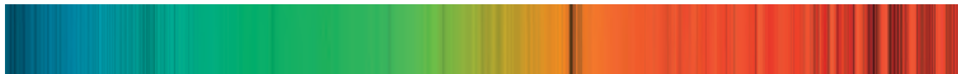
Das erste Spektrum mit dem SES (430-980nm). 10-Sekunden Aufnahme des K5III Sternes Alpha Tauri. Jede Farbe entspricht einer von 72 Echelle Ordnungen.
