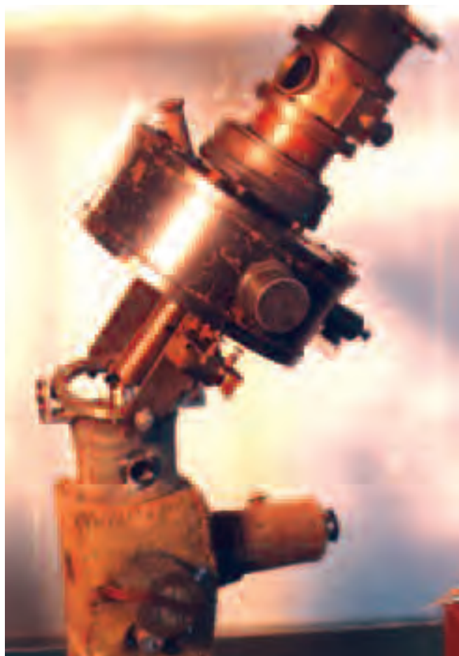
Weltweit erstes Sternphotometer mit Photozelle (P. Guthnick)
