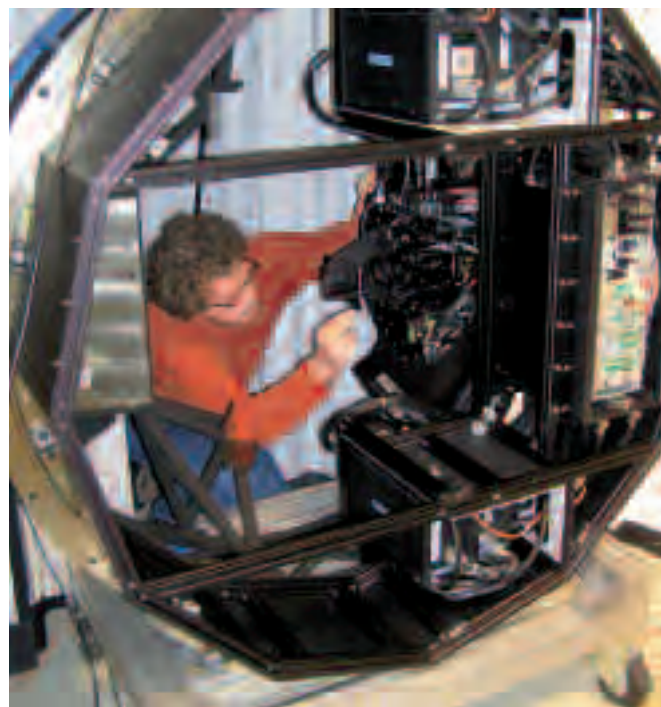
Fig. 4 Die AGW Einheit bei der Justage der Optik
