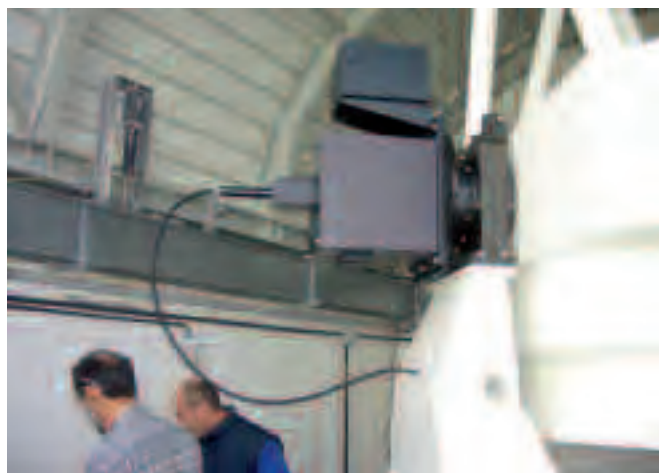
Die Akquisitions- und Nachführeinrichtung von STELLA-I mit dem Glasfaserkabel zum SES
