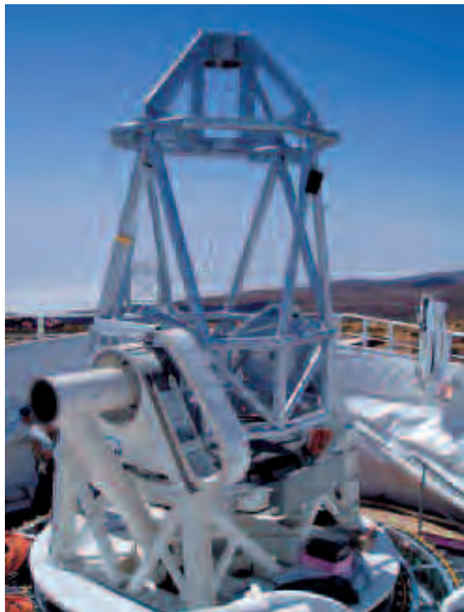
Abb.3: Teleskop-Struktur nach der Montage auf Teneriffa. Die Kuppel wurde hier heruntergeklappt.
