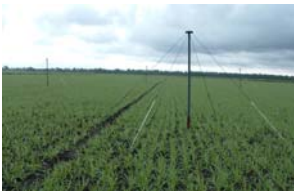
Abb. 1: LOFAR -Antennen für Radio-Wellenlängen 4-10 Meter (Bild: ASTRON Dwingeloo/ Niederlande)
